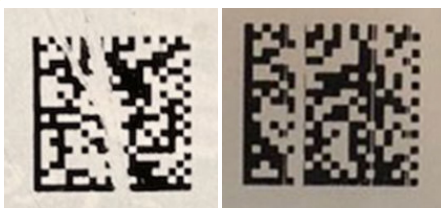
Нарушение целостности КМ*
